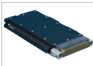
Рис.2. Вид модуля VPX-REDI на примере одноплатного компьютера VPX3-125 формата 3U
